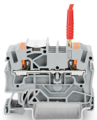
Prüfen mit einem Prüfstecker (Ø 2 mm), max. 42 V
