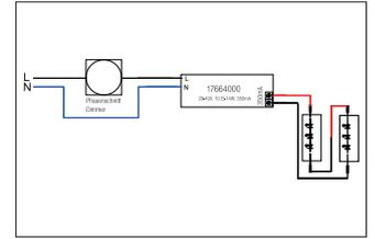
LED-Konverter 350 mA, Phasenabschnitt dimmbar. Dieser Konverter ist durch Sicherungseinrichtungen gegen Überspannung und Kurzschluss sowie thermische und elektrische Überlastung geschützt. Die Eingangs- und die Ausgangsklemme ist für Leitungen mit einem Querschnitt von bis zu 1,5 mm<sup>2</sup> geeignet. Material: Kunststoff, Schutzart raumseitig: nach DIN EN 60529: IP20, Schutzklasse: (EN 61140) II, Spannung: 230V AC 50Hz, Leistung: 14W, Dimmbar: Ja, Art der Dimmung: Phasenabschnitt.
