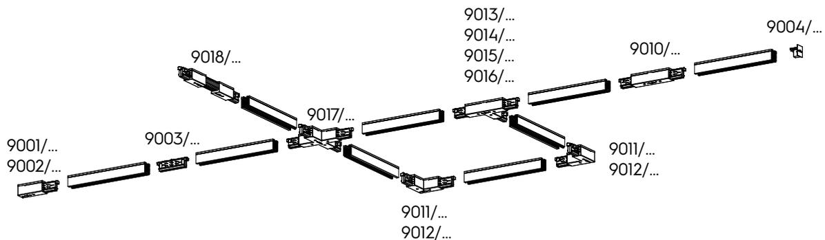
Ebenso haben Endverbinder und Stromverbinder einen meachnischen Schlüssel (wie im Bild dargestellt), der bei der auswahl der richtigen Komponente in Betracht gezogen werden muss. Im Katalog ist die Position des Schlüssel bei den entsprechenden Arikeln rot-gekennzeichnet.
