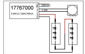
LED-Konverter 700 mA, 1-10 V dimmbar (analog). Dieser Konverter ist durch Sicherungseinrichtungen gegen Überspannung und Kurzschluss sowie thermische und elektrische Überlastung geschützt. Die Eingangs- und die Ausgangsklemme ist für Leitungen mit einem Querschnitt von bis zu 1,5 mm<sup>2</sup> geeignet.
