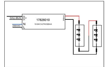
LED-Konverter 500 mA, DALI dimmbar (digital). Dieser Konverter ist durch Sicherungseinrichtungen gegen Überspannung und Kurzschluss sowie thermische und elektrische Überlastung geschützt. Die Eingangs- und die Ausgangsklemme ist für Leitungen mit einem Querschnitt von 0,75-1,5 mm<sup>2</sup> geeignet. Material: Kunststoff, Schutzart raumseitig: nach DIN EN 60529: IP20, Schutzklasse: (EN 61140) II, Spannung: 230V AC 50Hz , Leistung: 27W, Art der Dimmung: DALI-2.
