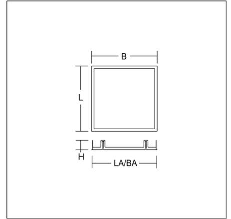
Einbaurahmen Stahlblech pulverbeschichtet, weiß. Zur Montage der Leuchte in abgehängte Decken. Werkzeugloser Einbau durch Federbefestigung. Einbautiefe mindestens 300 mm.
