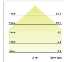
LED-Einbau- / Anbaudownlight X-FLAT, Blende nickel matt, rund. Ausgeführt in kompakter Bauform für werkzeuglose Schnellmontage zum Deckeneinbau. Leuchte optimiert zur Installation in Möbeln und Holzwerkstoffen.
