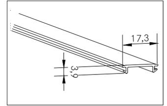
Flex-Klick-Abdeckungen: PC, schwarz. Material: Kunststoff, Abmessung Profil: L: 2.000 mm x B: 17,3 mm x H: 3,9 mm.
