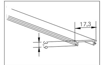
Flex-Klick-Abdeckungen: PC. Material: Kunststoff, Abmessung Profil: L: 100 mm x B: 17,3 mm x H: 3,9 mm.
