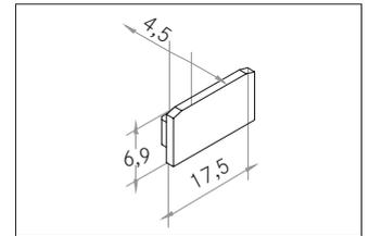
Endkappen-Set. In Verbindung mit den Profilabdeckungen 53440000 53440070 53440080 kann sowohl ein zusätzlicher mechanischer Schutz als auch eine optimale Lichtverteilung erreicht werden. Material: Kunststoff, Abmessung Profil: L: mm x B: 17,5 mm x H: 9,6 mm.
