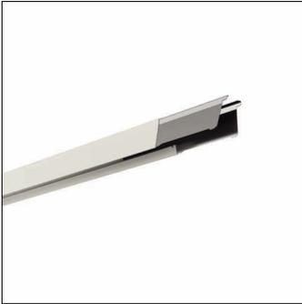
Licross®, Tragschiene, aus Stahlblech, verzinkt, bandlackiert, weiß, Länge: 4.500 mm, Breite: 64 mm, Höhe: 67mm, Durchverdrahtung: 14x 2,5mm<sup>2</sup>, mit Klemme, 14polig, max. 2,5mm<sup>2</sup>, Schutzart (gesamt): maximal IP64, abhängig von den verwendeten Einsätzen und Zubehör, Schutzklasse (gesamt): SK I (Schutzerdung), Prüfzeichen: CE, Verpackungseinheit: 1 Stück
