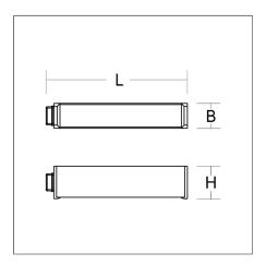
Anfangseinspeisung, 14-polig, Anschluss Stecker. Gehäuse Aluminium-Strangpressprofil pulverbeschichtet. Abdeckung Kunststoff in Gehäusefarbe. LINEDO Steckersystem aus Kunststoff schwarz. 2 Kabelverschraubungen (M20 und M25). Kabelverschraubungen wahlweise seitlich oder oben. Komfortabler Anschluss für starre und flexible Leitungen.
