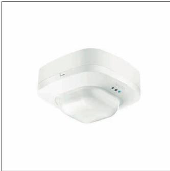
IR-Quattro HD, Präsenzmelder, Montageart: Anbau, Netzanschluss: 220..240V, AC, 50/60Hz, Gehäuse, aus Kunststoff, reinweiß (RAL 9010), Länge: 120 mm, Breite: 120 mm, Höhe: 65mm, Multisensorlokale SteuerungAusstattung: Master, Schutzart (gesamt): IP20, Schutzklasse (gesamt): SK II (Schutzisoliert), Prüfzeichen: CE, VDE, zul. Umgebungstemperatur für Innenräume: 0..+40°C, Verpackungseinheit: 1 Stück
