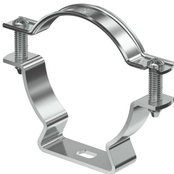
Abstandschelle zur Montage von Rohren und Kabeln an Wand, Decke und Boden. Mit selbstsicherndem Oberteil. Befestigung über Langloch. Ab der Schellengröße 20 geeignet für Montage mit Nagelgerät oder Bolzensetzgerät. Zugelassen für den Funktionserhalt nach DIN 4102 Teil 12, Funktionserhaltklassen E 30 bis E 90 (außer ALU).
