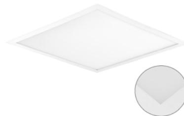
LED Einbaupanel für Systemdecken mit sichtbaren Tragschienen. In Kombination mit der separat erhältlichen Seilabhängung bzw. dem separat erhältlichen Aufbaurahmen kann die Leuchte als Pendelleuchte bzw. als Anbauleuchte eingesetzt werden. Die Lieferung erfolgt inkl. externem Netzgerät (DALI / flicker free), welches mit der Leuchte einfach über ein Stecksystem verbunden wird. Der Blendwert beträgt UGR kleiner 19, die Gehäusefarbe ist ähnlich RAL9016. Das Panel hat einen 3-Step-MacAdam.
