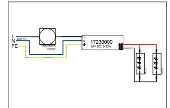
LED-Netzgerät 24 V DC, dimmbar.. Material: Kunststoff, Schutzart raumseitig: nach DIN EN 60529: IP20, Schutzklasse: (EN 61140) II, Spannung: 24V, Leistung: 30W, Art der Dimmung: Phasenabschnitt.
