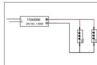
LED-Netzgerät 24 V DC, schaltbar.. Material: Kunststoff, Schutzart raumseitig: nach DIN EN 60529: IP20, Schutzklasse: (EN 61140) II, Spannung: 24 V, Leistung: 60W, Art der Dimmung: schaltbar.
