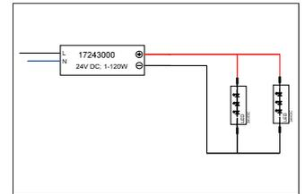
LED-Netzgerät 24 V DC, schaltbar.. Material: Kunststoff, Schutzart raumseitig: nach DIN EN 60529: IP20, Schutzklasse: (EN 61140) II, Spannung: 24 V, Leistung: 120W, Art der Dimmung: schaltbar.
