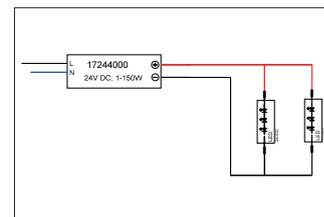
LED-Netzgerät 24 V DC, schaltbar.. Material: Kunststoff, Schutzart raumseitig: nach DIN EN 60529: IP20, Schutzklasse: (EN 61140) II, Spannung: 24 V, Leistung: 150W, Art der Dimmung: schaltbar.
