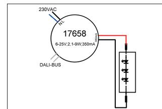
LED-Rundkonverter 350 mA, DALI dimmbar (digital). Dieser Konverter ist durch Sicherungseinrichtungen gegen Überspannung und Kurzschluss sowie thermische und elektrische Überlastung geschützt. Material: Kunststoff, Schutzart raumseitig: nach DIN EN 60529: IP20, Schutzklasse: (EN 61140) II, Spannung: 230V AC 50Hz, Leistung: 9W, Dimmbar: Ja, Art der Dimmung: DALI-2.
