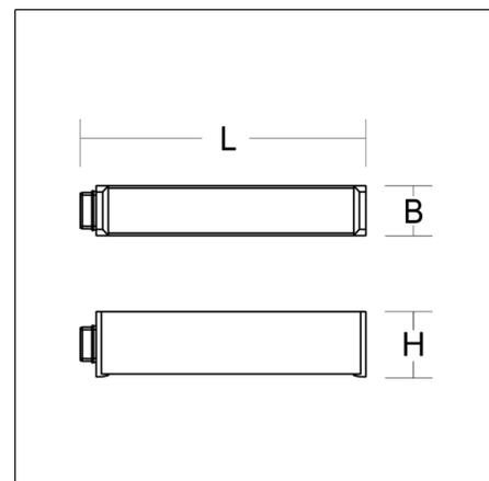
Anfangseinspeisung, 14-polig, Anschluss Buchse. Gehäuse Aluminium-Strangpressprofil eloxiert. Abdeckung Kunststoff in Gehäusefarbe. LINEDO Steckersystem aus Kunststoff hellgrau. 2 Kabelverschraubungen (M20 und M25). Kabelverschraubungen wahlweise seitlich oder oben. Komfortabler Anschluss für starre und flexible Leitungen. Speziell für die Verwendung bei Lichtbandmodulen mit hohem opalen Diffusor.
