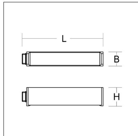
Anfangseinspeisung, 14-polig, Anschluss Stecker. Gehäuse Aluminium-Strangpressprofil eloxiert. Abdeckung Kunststoff in Gehäusefarbe. LINEDO Steckersystem aus Kunststoff hellgrau. 2 Kabelverschraubungen (M20 und M25). Kabelverschraubungen wahlweise seitlich oder oben. Komfortabler Anschluss für starre und flexible Leitungen. Speziell für die Verwendung bei Lichtbandmodulen mit hohem opalen Diffusor.
