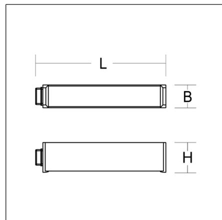
Anfangseinspeisung, 7-polig, Anschluss Buchse. Gehäuse Aluminium-Strangpressprofil pulverbeschichtet. Abdeckung Kunststoff in Gehäusefarbe. LINEDO Steckersystem aus Kunststoff hellgrau. 2 Kabelverschraubungen (M20 und M25). Kabelverschraubungen wahlweise seitlich oder oben. Komfortabler Anschluss für starre und flexible Leitungen. Speziell für die Verwendung bei Lichtbandmodulen mit hohem opalen Diffusor.
