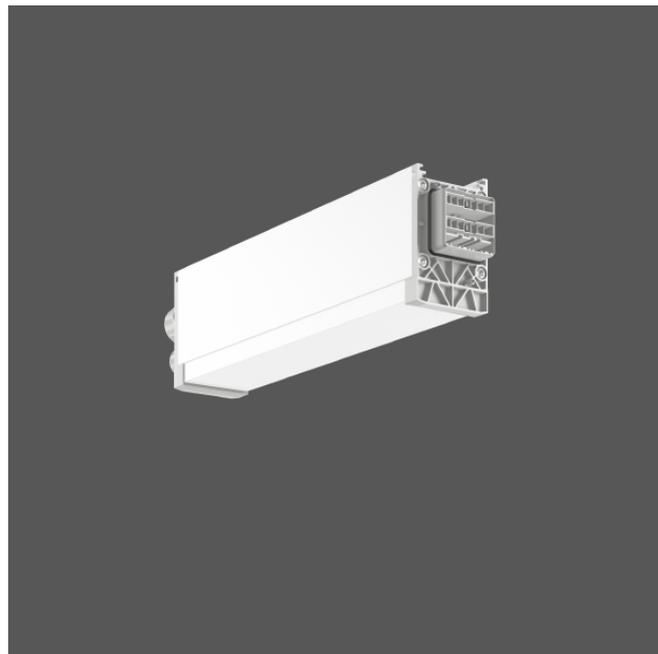
Anfangseinspeisung, 7-polig, Anschluss Stecker. Gehäuse Aluminium-Strangpressprofil pulverbeschichtet. Abdeckung Kunststoff in Gehäusefarbe. LINEDO Steckersystem aus Kunststoff hellgrau. 2 Kabelverschraubungen (M20 und M25). Kabelverschraubungen wahlweise seitlich oder oben. Komfortabler Anschluss für starre und flexible Leitungen. Speziell für die Verwendung bei Lichtbandmodulen mit hohem opalen Diffusor.
