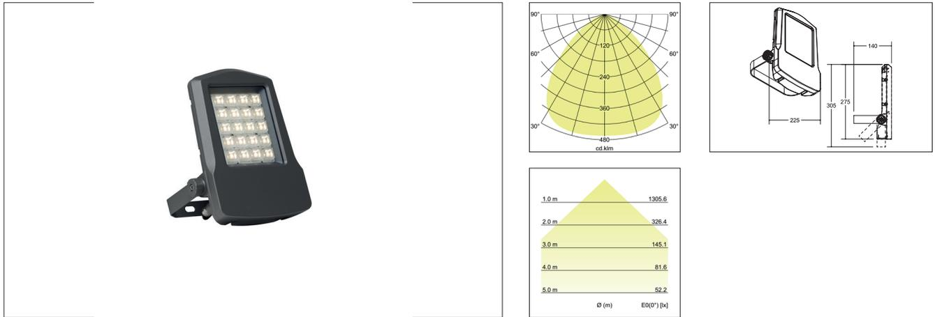
LED-Mastleuchte, titan, quadratisch. Ausführung in kompakter Bauform für die harmonische Implementierung in stimmige, architektonische Raumkonzepte Montageart: Anbaumontage, Montageort: Wandmontage, Material: Aluminium / Glas, Schutzart: nach DIN EN 60529: IP66, Schutzklasse: (EN 61140) I, Spannung: 230V AC 50Hz, Leistung: 20W, Lichtstrom: 2.810lm, Farbtemperatur: 3000 K, Abstrahlwinkel: 100°, Verstellbarkeit: schwenkbar, mit Betriebsgerät, Art der Dimmung: schaltbar .
