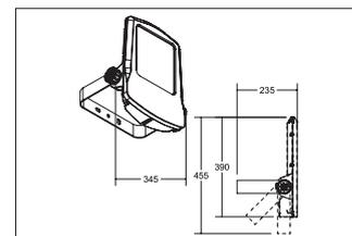
LED-Mastleuchte, titan, quadratisch Montageart: Anbaumontage, Montageort: Wandmontage, Material: Aluminium / Glas, Schutzart: nach DIN EN 60529: IP66, Schutzklasse: (EN 61140) I, Spannung: 230V AC 50Hz, Leistung: 50W, Lichtstrom: 6.948lm, Farbtemperatur: 4000 K, Abstrahlwinkel: 100°, Verstellbarkeit: schwenkbar, mit Betriebsgerät, Art der Dimmung: schaltbar .
