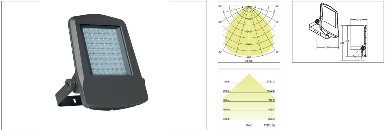
LED-Mastleuchte, titan, quadratisch. Ausführung in kompakter Bauform für die harmonische Implementierung in stimmige, architektonische Raumkonzepte Montageart: Anbaumontage, Montageort: Wandmontage, Material: Aluminium / Glas, Schutzart: nach DIN EN 60529: IP66, Schutzklasse: (EN 61140) I, Spannung: 230V AC 50Hz, Leistung: 100W, Lichtstrom: 14.591lm, Farbtemperatur: 4000 K, Abstrahlwinkel: 100°, Verstellbarkeit: schwenkbar, mit Betriebsgerät, Art der Dimmung: schaltbar .
