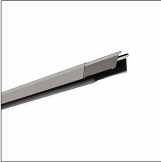
Licross®, Tragschiene, aus Stahlblech, verzinkt, bandlackiert, weißaluminium (RAL 9006), Länge: 3.000 mm, Breite: 64 mm, Höhe: 67mm, Durchverdrahtung: 5x 2,5mm<sup>2</sup>, Schutzart (gesamt): maximal IP64, abhängig von den verwendeten Einsätzen und Zubehören, Schutzklasse (gesamt): SK I (Schutzerdung), Prüfzeichen: CE, Verpackungseinheit: 1 Stück
