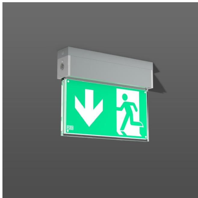
Leuchte zur Rettungswegkennzeichnung. Gehäuse Aluminium-Strangpressprofil pulverbeschichtet. 4 Rettungszeichenfolien und 1 weiße Folie inklusive Befestigungs-Pins zum Aufstecken beigelegt. Universal Befestigungssatz für Decken- und Wandanbau.
