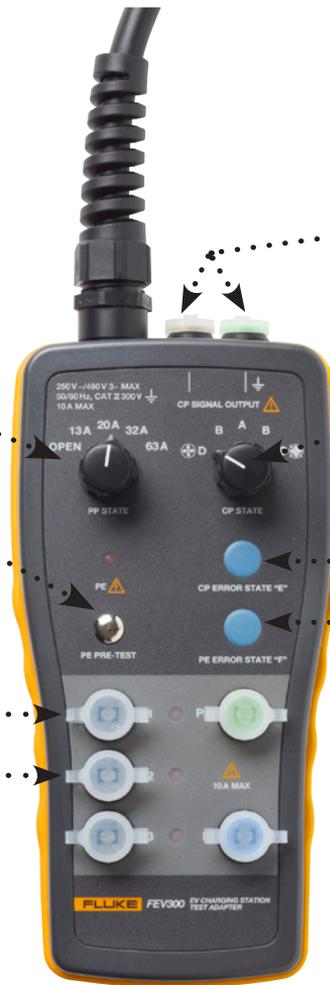
**Anschlüsse** für den CP-Signalausgang zur Überprüfung des Kommunikationsprotokolls
