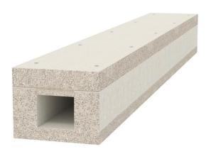
Brandschutzkanal aus wasser- und frostbeständigen Glasfaserleichtbeton der Baustoffklasse A1 gemäß EN 13501-1 zur brandsicheren Verlegung von Kabeln in Flucht- und Rettungswegen und zum Funktionserhalt sicherheitsrelevanter Anlagen. Klassifizierung I90 als I-Kanal gemäß DIN 4102 Teil 11 und Klassifizierung E30 als E-Kanal gemäß DIN 4102 Teil 12.
