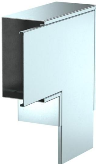
Flachwinkel mit intumeszierendem Brandschutzgewebe für Installationskanal PY-ROLINE® Rapid PLM. Geeignet für die direkte Wand- und Deckenmontage, Montage unterhalb von Systemböden und auf Tragsystemen. Werkzeuglose Stoßstellenmontage mit Stoßstellenverbinder PLM SI. Der Deckel wird werkzeuglos aufgerastet und ermöglicht eine schnelle Revision und Nachbelegung. Deckelüberstand ermöglicht versetzte Deckelmontage für durchgängigen Potentialausgleich der gesamten Kanalstrecke.
