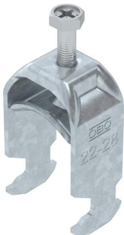
Bügelshelle mit Hammerkopf-Fuß, Metalldruckwanne mit gerundeten Kanten für Kabelschutz. Zur vertikalen und horizontalen Montage von 1 Einzelkabel an C-Profilshiene. Für Schlitzweite 16 - 17 mm. Mit 1-gängiger Schraube an Druckwanne, universeller Sechskant-Schraubenkopf SW10, mit Schlitz und Kreuzschlitz. Geeignet für Montage im Innen- und Außenbereich. Gegenwanne muss separat bestellt werden.
