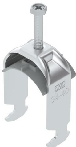
Bügelschelle mit Hammerkopf-Fuß, Kunststoffdruckwanne aus Polypropylen. Zur vertikalen und horizontalen Montage von 1 Einzelkabel an C-Profilschiene. Für Schlitzweite 16 - 17 mm. Mit 1-gängiger Schraube an Druckwanne, universeller Sechskant-Schraubenkopf SW10, mit Schlitz und Kreuzschlitz. Geeignet für Montage im Innen- und Außenbereich. Der Einsatz einer Gegenwanne wird empfohlen.
