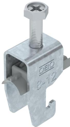
Bügelschelle mit U-Fuß, Kunststoffdruckwanne aus Polypropylen. Zur vertikalen und horizontalen Montage von 1 Einzelkabel an C-Profilschiene. Für Schlitzweite 18 - 22 mm. Mit 1-gängiger Schraube an Druckwanne, universeller Sechskant-Schraubenkopf SW10, mit Schlitz und Kreuzschlitz. Geeignet für Montage im Innen- und Außenbereich. Der Einsatz einer Gegenwanne wird empfohlen.
