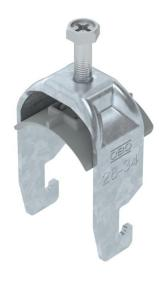
Bügelschelle mit U-Fuß, Kunststoffdruckwanne aus Polypropylen. Zur vertikalen und horizontalen Montage von 1 Einzelkabel an C-Profilschiene. Für Schlitzweite 18 - 22 mm. Mit 1-gängiger Schraube an Druckwanne, universeller Sechskant-Schraubenkopf SW10, mit Schlitz und Kreuzschlitz. Geeignet für Montage im Innen-und Außenbereich. Der Einsatz einer Gegenwanne wird empfohlen.
