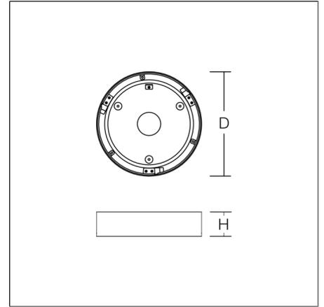
Anbaugehäuse Stahlblech pulverbeschichtet. Downlight werkzeuglos verriegelbar. Für Einbau-Downlight TOLEDO FLAT+ round.
