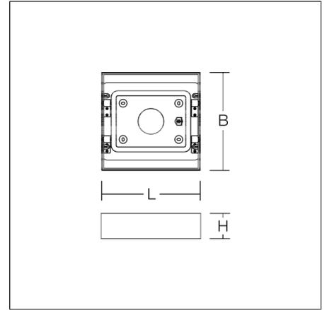
Anbaugehäuse Stahlblech pulverbeschichtet. Downlight werkzeuglos verriegelbar. Für Einbau-Downlight TOLEDO FLAT+ square. Nicht geeignet für Ausführung Tunable White
