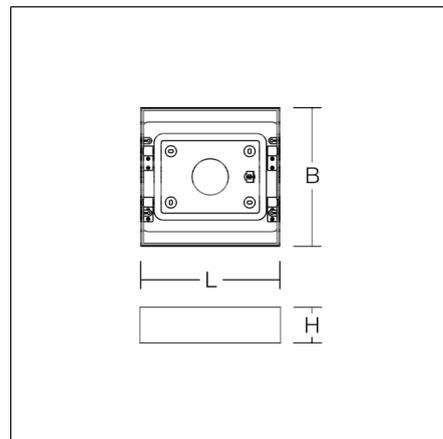
Anbaugehäuse Stahlblech pulverbeschichtet. Downlight werkzeuglos verriegelbar. Für Einbau-Downlight TOLEDO FLAT+ square.
