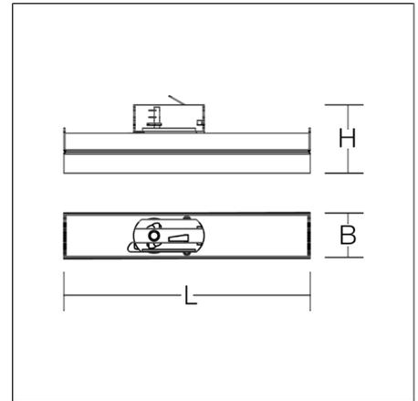
3-Phasen-Stromschienenadapter für GSUN S/D. Multi-Adapter für 3-Phasen-Stromschienen aller bekannten Hersteller
