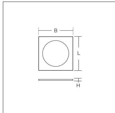
Einlegerahmen für Rasterdecken Modulmaß 600. Rahmen aus Stahlblech, pulverbeschichtet. Für Einbau-Downlight TOLEDO FLAT+ round D 470.
