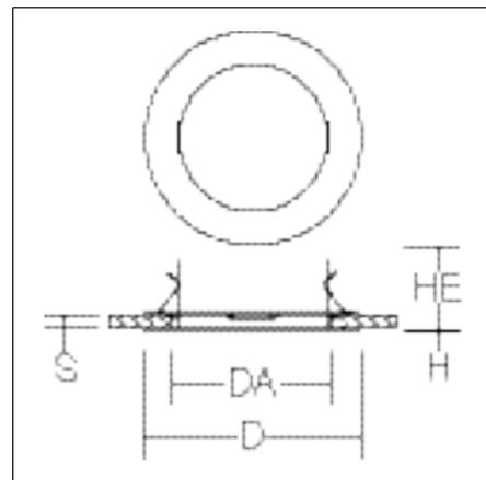
Einbaurahmen Stahlblech blank/pulverbeschichtet (2-teilig) zur werkzeuglosen Montage von Einbauleuchten in bauseits vorhandene Deckenausschnitte. Federbefestigung. Vorhandener Deckenausschnitt:  $\varnothing$  160 - 210 mm. Geeignet für Einbauleuchten mit Deckenausschnitt: DA 145 - 155 mm.
