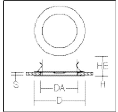
Einbaurahmen Stahlblech blank/pulverbeschichtet (2-teilig) zur werkzeuglosen Montage von Einbauleuchten in bauseits vorhandene Deckenausschnitte. Federbefestigung. Vorhandener Deckenausschnitt:  $\varnothing$  265 - 315 mm. Geeignet für Einbauleuchten mit Deckenausschnitt: DA 250 - 260 mm.
