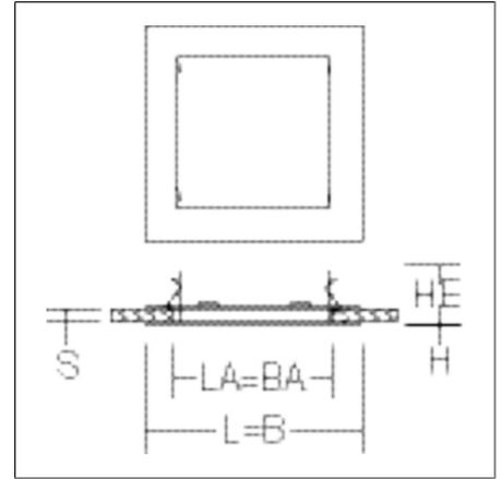
Einbaurahmen Stahlblech blank/pulverbeschichtet (2-teilig) zur werkzeuglosen Montage von Einbauleuchten in bauseits vorhandene Deckenausschnitte. Federbefestigung. Vorhandener Deckenausschnitt: LxAxB 145 - 195 mm. Geeignet für Einbauleuchten mit Deckenausschnitt: LxAxB 130 - 140 mm.
