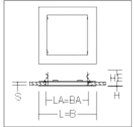
Einbaurahmen Stahlblech blank/pulverbeschichtet (2-teilig) zur werkzeuglosen Montage von Einbauleuchten in bauseits vorhandene Deckenausschnitte. Federbefestigung. Vorhandener Deckenausschnitt: LxAxB 225 - 275 mm. Geeignet für Einbauleuchten mit Deckenausschnitt: LxAxB 210 - 220 mm.
