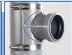
Einfache Montage: Loch bohren Ø 86 mm, entgraten, Dichtung aufkleben, Sattel-Abzweig aufsetzen, Schlauchschellen leicht andrehen. **FERTIG!**
