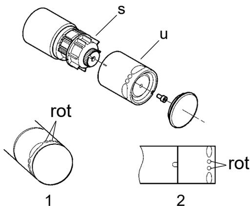
**4.18** Den Temperaturwahlgriff (u) mit der Schraube (v) an der Armatur fixieren.
