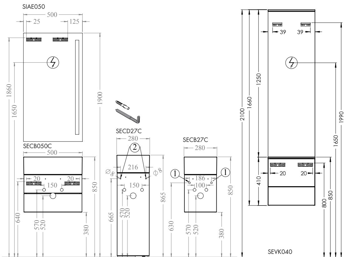
**(1) Stockschrauben sind im Lieferumfang nicht enthalten!** // Hanger bolts are not included in the delivery! // Les vis sans tête à filetage partiel bois ne sont pas fournies. // De producten moeten aan alle geplande montagepunten bevestigd worden. // Le viti a doppia filettatura non sono fornite in dotazione! // Винты-шурупы не входят в комплект поставки!
