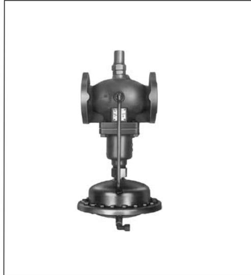
Der Regler ist ein direkt wirkender Proportionalregler ohne Fremdenergie zur Differenzdruckregelung und zur Begrenzung des Volumenstroms und wird hauptsächlich in Fernwärmeversorgungsanlagen eingesetzt.
