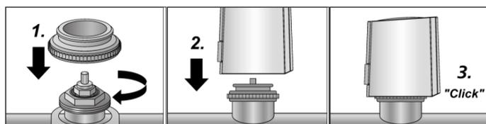
Die Ventilanpassung erfolgt über einen Ventiladapter der in diversen Ausführungen für die gängigsten Ventilunterteile und Heizkreisverteiler lieferbar ist (bei Bestellung berücksichtigen)
