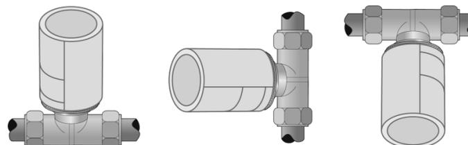
Der Antrieb ist bevorzugt in senkrechter und waagrechter Montagelage einzubauen. Bei "über Kopf"-Montage können spezielle Umstände (z.B. Schmutzwasser) die Lebensdauer reduzieren.
