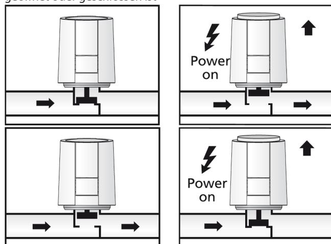
Bei der Ausführung NC, stromlos geschlossen, fährt die Funktionsanzeige aus, wenn das Ventil öffnet
